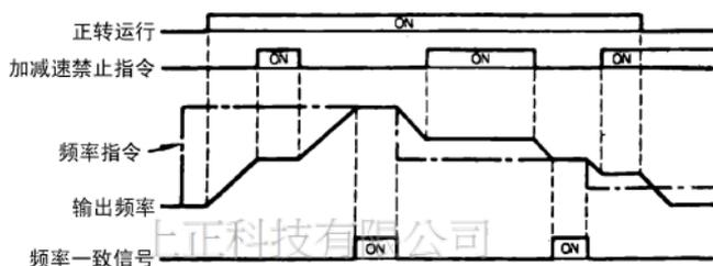
(注) 在加减速禁止指令输入状态下输入正转(反转)运行指令时，电机不运转。但是，设定为频率指令下限 (n31)  $\geq$  最低输出频率 (n14) 时，电机将以频率指令下限 (n31) 运转。
