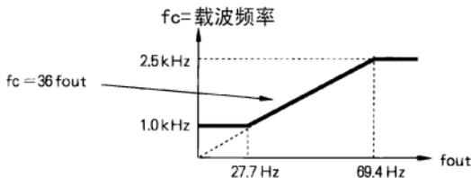
出厂时的设定值如下表所示根据变频器的容量 (kVA) 大小而不同。
