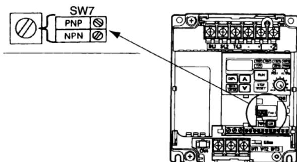
根据顺控器输入信号 (S1-S5) 的极性 (0V 公共点时 NPN 侧, +24V 公共点时 PNP 侧), 切换开关 SW1。出厂时已设定在 NPN 侧。
