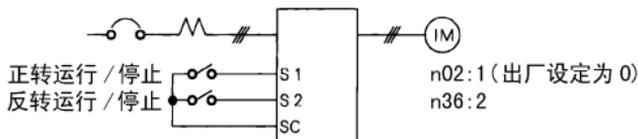
○ 用通信方式进行运行 / 停止指令 (安装选配卡)
