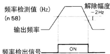
• 频率检测 2 (输出频率  $\leq$  频率检测值 n58)
