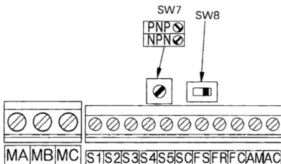
SW7 开关，请根据顺控器输入信号（S1~S5）的极性（0V 公共点时 NPN 侧，+24V 公共点时 PNP 侧）进行切换。出厂设定在 NPN 侧。
