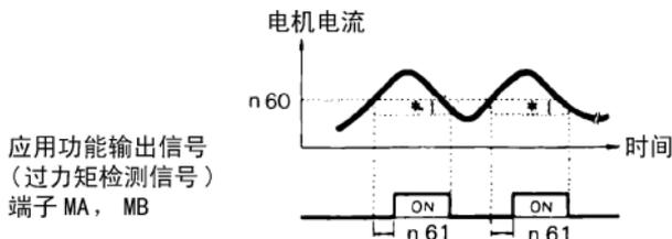
\* 过力矩检测的滞后量, 约为电机额定电流的 5%
